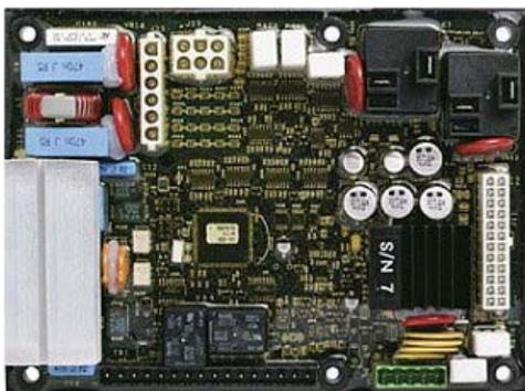
PowerCommand™ 1.1 е микропроцесорно базирана система за мониторинг и управление на генераторната система. Тя е посредник между оператора и генератора. Контролната система обезпечава цифровото регулиране на напрежението и следене на трите му фази, управлението и функциите за защита на генераторната система. Контролната система PCC 1.1 е пригодена за експлоатация на широк спектър генераторни системи.
